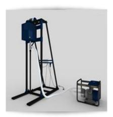
МГБУ «Гамма» - это разборная установка, применяемая для работ по производству скважины на воду, бурению шнеком под столбы и заборы. Глубина бурения 80м., диаметр 250мм. С помощью МГБУ «Гамма» есть возможность работать в труднодоступных местах (там, где не имеет возможности проехать большая техника, не повредив при этом окружающий ландшафт), в стесненных условиях, таких как подвальные помещения, гаражи, сараи, внутри домов.
