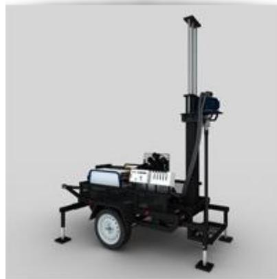
Буровые установки серии «Омега» предназначены для бурения вертикальных и наклонных скважин вращательным способом с использованием шнекового и колонкового инструмента.
